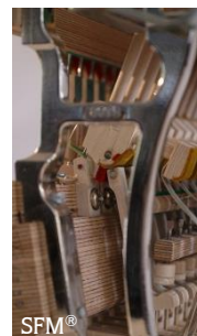
Fig.: 122 T comes with an additional, sympathetically vibrating soundboard, and the Classic Steingraeber action or SFM® action. Abb.: 122 T verfügt über einen mitklingenden Nebenresonanzboden sowie die klassische Steingraeber-Mechanik oder SFM®.
